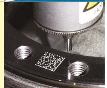
Маркировка детали 2D кодом
