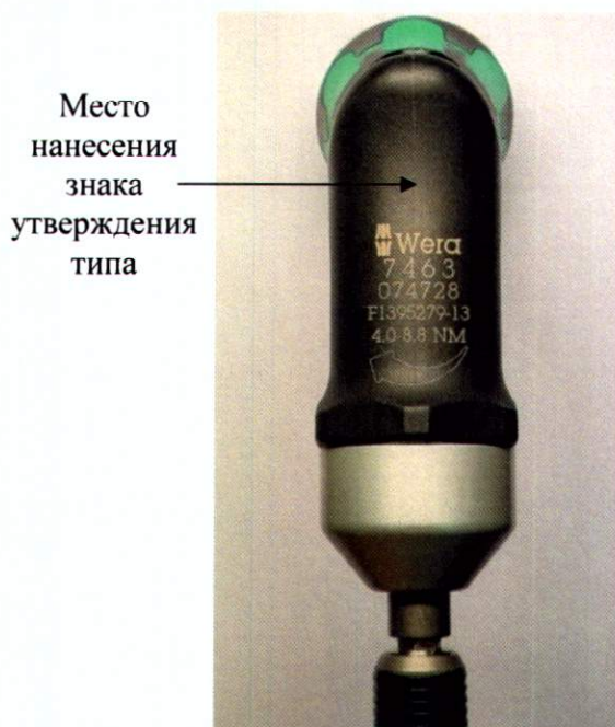
Рисунок 15 - Пример нанесения идентификационных данных отвертки моментной предельной WERA модификации 7400 Pre-Set Kraftform, исполнения 7463 Pre-Set
