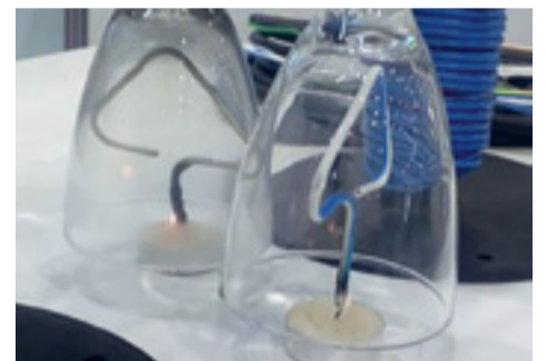
Испытание пожаробезопасных кабелей огнем: в прозрачном бокале – ППГнг(A)-HF, в мутном – ВВГнг(A)-LSLTx
